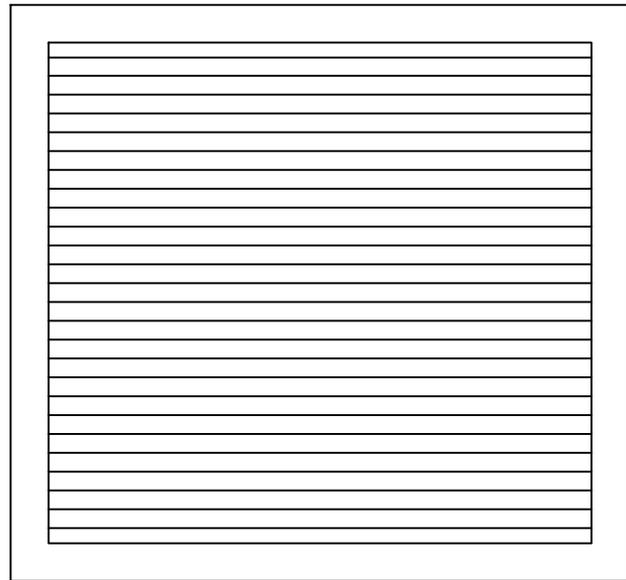
freier physischer Lüftungsquerschnitt 50 % (höhere Werte auf Anfrage)
