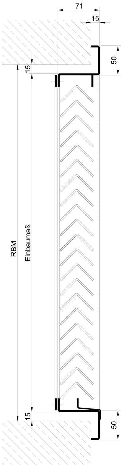
Freier physischer Lüftungsquerschnitt 50 % (höhere Werte auf Anfrage)
